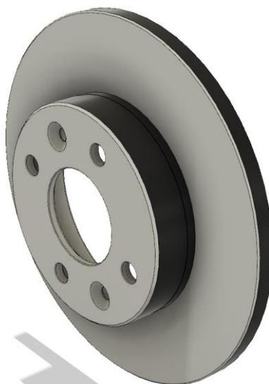
**Fig. 7 Brake disc.**
