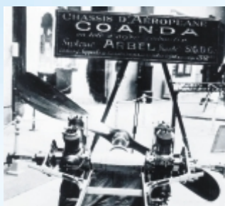
Cele două motoare rotative Gnom ale avionului Twin-motor cu o singură elice, prezentat la Reims în 1911.
